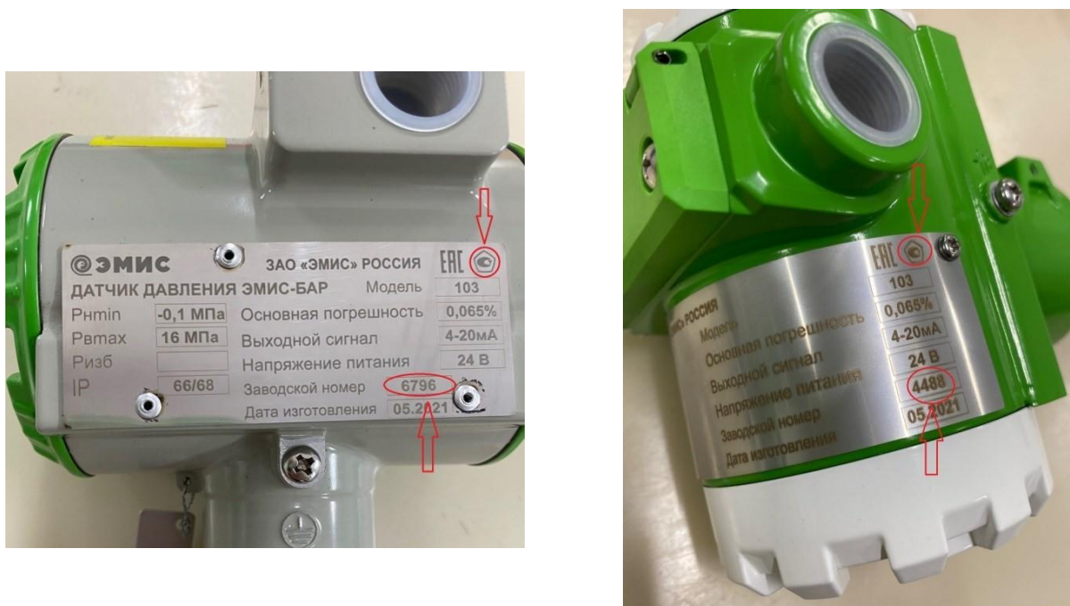
Рисунок 2 – Места расположения заводского номера и знака утверждения типа. Знак поверки датчиков наносится в паспорт датчика и (или) свидетельство
